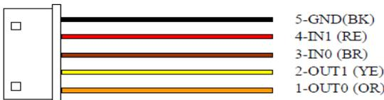
**Wiegand Cable (5P) "Cable de control para tecnologías de tarjetas de proximidad" (105)**
